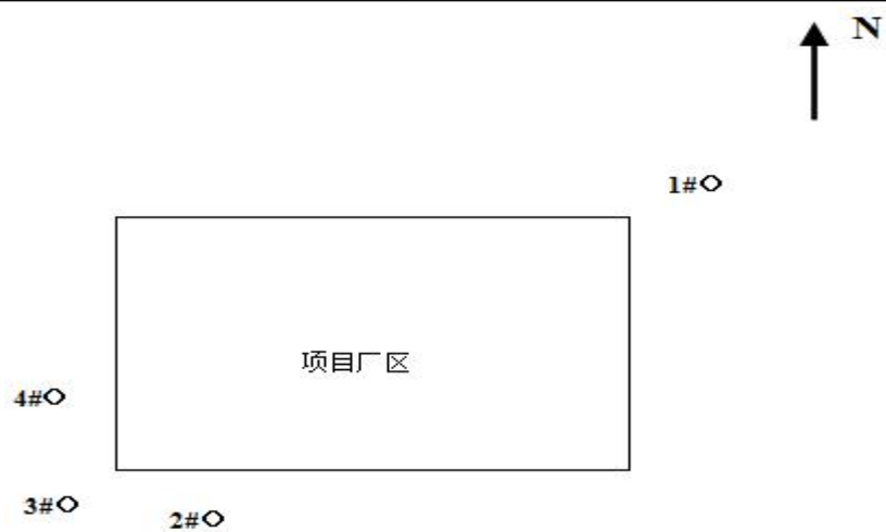
图 7-2 无组织废气检测布点示意图
